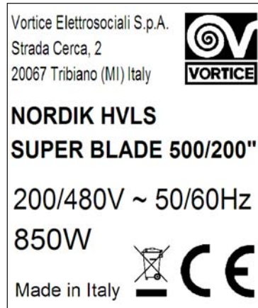
Fig. 1 - Beispiel Typenschild für SUPER BLADE 500/200"
